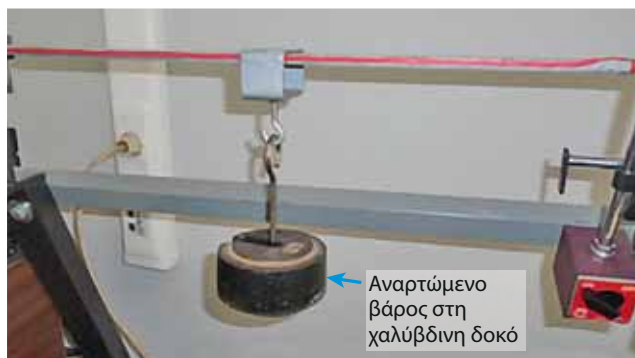
Εικόνα Π2-1. Πειραματική διάταξη δοκού υπό καθαρή κάμψη στο κεντρικό τμήμα της.
