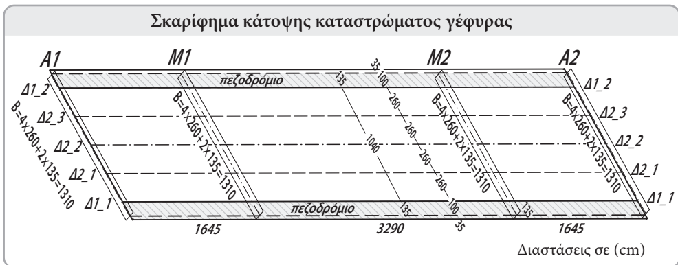
Σχήμα 6.1.1.1. Σκαρίφημα κάτοψης καταστρώματος γέφυρας.
