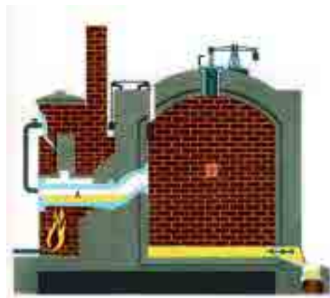
Σχήμα 4. Κάμινος απόσταξης του θείου. Το λυωμένο θείο χύνεται σε κύλινδρο από χυτοσίδηρο Α και θερμαίνεται σε θερμοκρασία υψηλότερη από το σ.τ. του θείου. Οι ατμοί οδηγούνται σε πλινθόκτιστο θάλαμο Β με βαλβίδα ασφαλείας Γ όπου ψύχονται. Αν η θερμοκρασία του θαλάμου Β είναι κατώτερη των 112 °C οι ατμοί συμπυκνώνονται στα τοιχώματα με τη μορφή πολύ λεπτής σκόνης, τα «άνθη θείου». Αν η θερμοκρασία είναι μεγαλύτερη των 112 °C οι ατμοί συμπυκνώνονται προς υγρό θείο, που συγκεντρώνεται σε ειδικά ξύλινα καλούπια και στερεοποιείται σε πλάκες.
