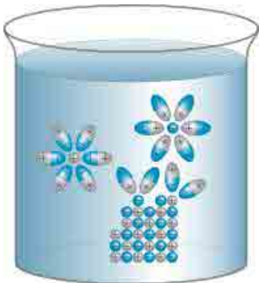
Εικόνα 5. Σχηματική παράσταση της διεργασίας της διάλυσης του \text{NaCl} στο νερό που περιλαμβάνει και την εφυδάτωση των ιόντων \text{Na}^+ και \text{Cl}^- .
