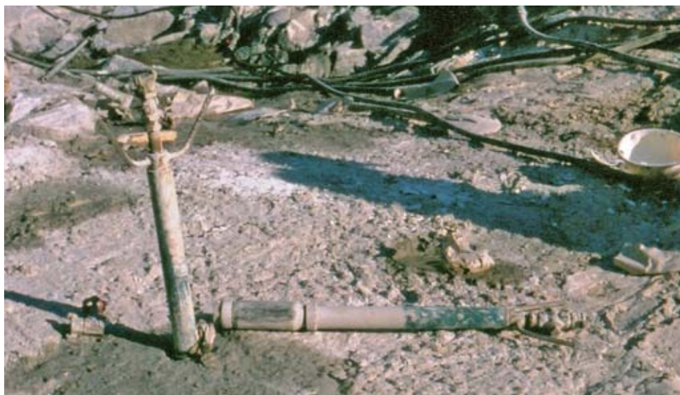
Φωτ. 5.5.13. Το μηχανικό racker έχει στο κατώτερο άκρο του ελαστικό δακτύλιο, ο οποίος φουσκώνει, όταν περιστρέφουμε τα δύο κέρατα (επάνω) και το μεταλλικό στέλεχος βιδώνει προς τα κάτω πιέζοντας τον ελαστικό δακτύλιο. Ο δακτύλιος εφαρμόζει ερμητικά στα τοιχώματα της οπής του σκυροδέματος.
