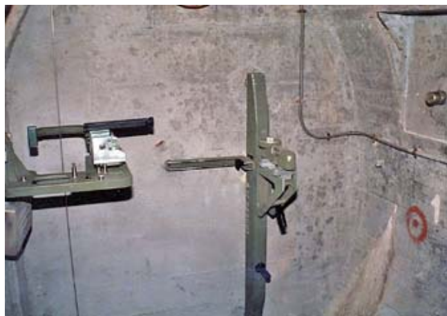
Φωτ. 4.19-20. Στο εσωτερικό των τοξωτών φραγμάτων είναι εγκατεστημένα όργανα για την παρακολούθηση του φράγματος και τις πιθανές αποκλίσεις, που εάν φτάσουν τα όρια επικινδυνότητας, λαμβάνονται μέτρα αντιμετώπισης, με πρώτο το άδειασμα του ταμιευτήρα.
