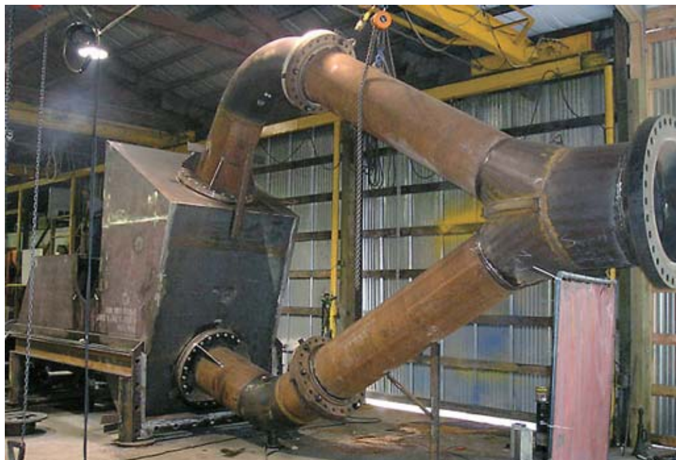
Φωτ. 6.6. Συναρμολόγηση των 2 αγωγών που οδηγούν το νερό στα 2 ακροφύσια.
