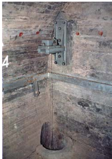
Φωτ. 4.19-20. Στο εσωτερικό των τοξωτών φραγμάτων είναι εγκατεστημένα όργανα για την παρακολούθηση του φράγματος και τις πιθανές αποκλίσεις, που εάν φτάσουν τα όρια επικινδυνότητας, λαμβάνονται μέτρα αντιμετώπισης, με πρώτο το άδειασμα του ταμιευτήρα.
