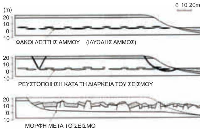
Σχήμα 1.33: Πλήρης αστοχία λόγω ρευστοποίησης φακών χαλαρής κορεσμένης αμμοίλου σε βάθος 15m από την επιφάνεια (Σεισμός Anchorage, Alaska, 1964, M = 8.2 ).
