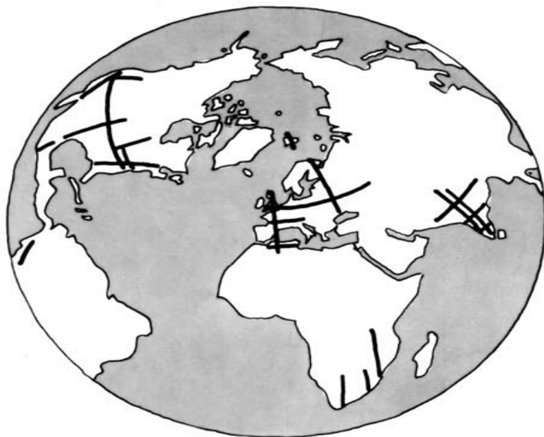
Σχ. 1.3. Τα κυριότερα τόξα μεσημβρινών και παραλλήλων που μετρήθηκαν για τον προσδιορισμό του σχήματος και των διαστάσεων της Γης μέχρι και τον 19ο αιώνα.
