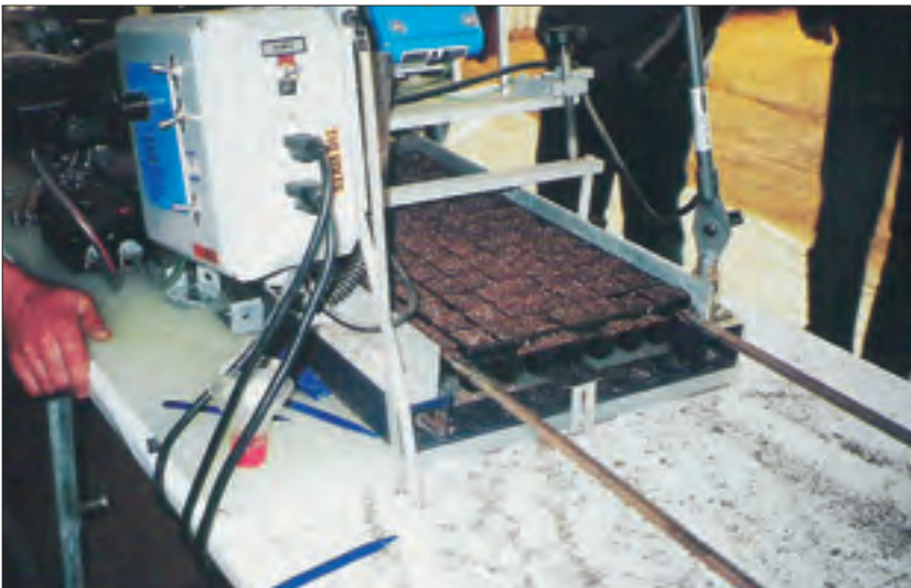
Εικ. 1. Αυτόματη σπαστική πνευματική μηχανή για σπορά σε κυψελίδες πλαστικών δίσκων.
