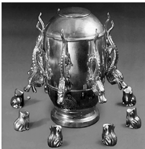
Σχ. 1.2. Το πρώτο σεισμολόγιο που κατασκευάστηκε το 132 μ.Χ. από τον Κινέζο φιλόσοφο Zhang Heng (78-132 μ.Χ.). Το σεισμολόγιο περιείχε εκκρεμές (κατακόρυφος κύλινδρος) το οποίο, αποκρινόμενο στην εδαφική δόνηση, ωθούσε μέσω μοχλών σφαιρίδια να πέσουν σε υποδοχείς (ανοικτά στόματα βατράχων) που βρίσκονται στη βάση του.
