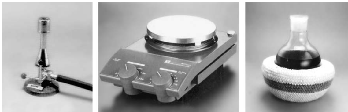
Εικόνα 3. Θέρμανση σε λύχνο Bunsen, σε θερμαινόμενες πλάκες, σε μανδύα
