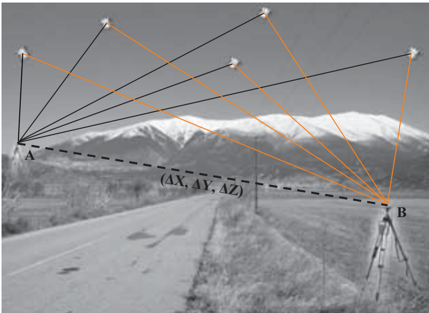
Σχήμα 1.3: Βασική αρχή GPS για το σχετικό προσδιορισμό θέσης: Δύο δέκτες που μετρούν ταυτόχρονα στα άκρα μιας βάσης.
