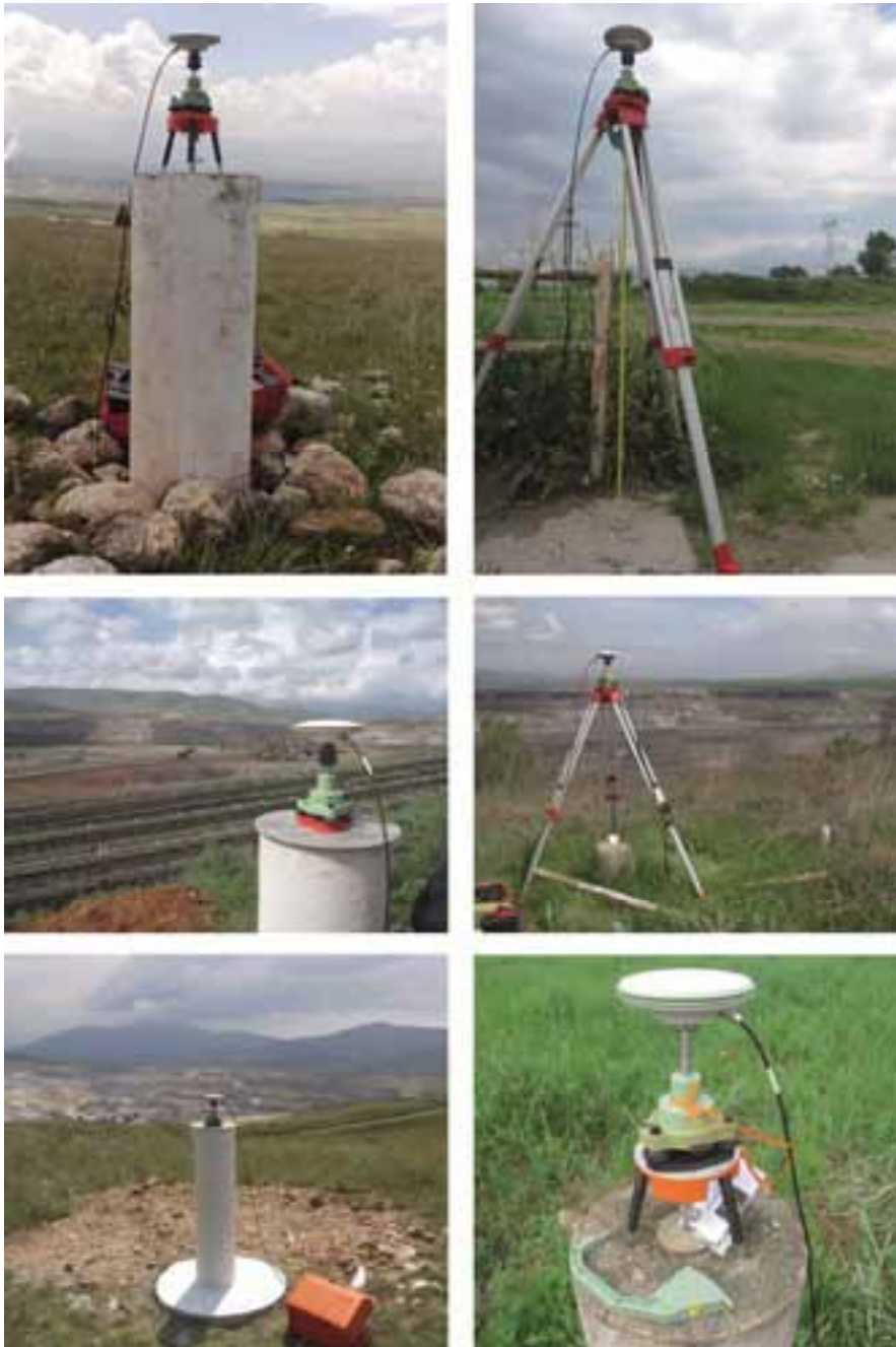
Σχήμα 3.13: Δέκτες και κεραίες GPS/GNSS σε βάθρα και τρίποδα από πραγματικές μετρήσεις δικτύων (περιοχή Λιγνιτικού Κέντρου Δυτικής Μακεδονίας)
