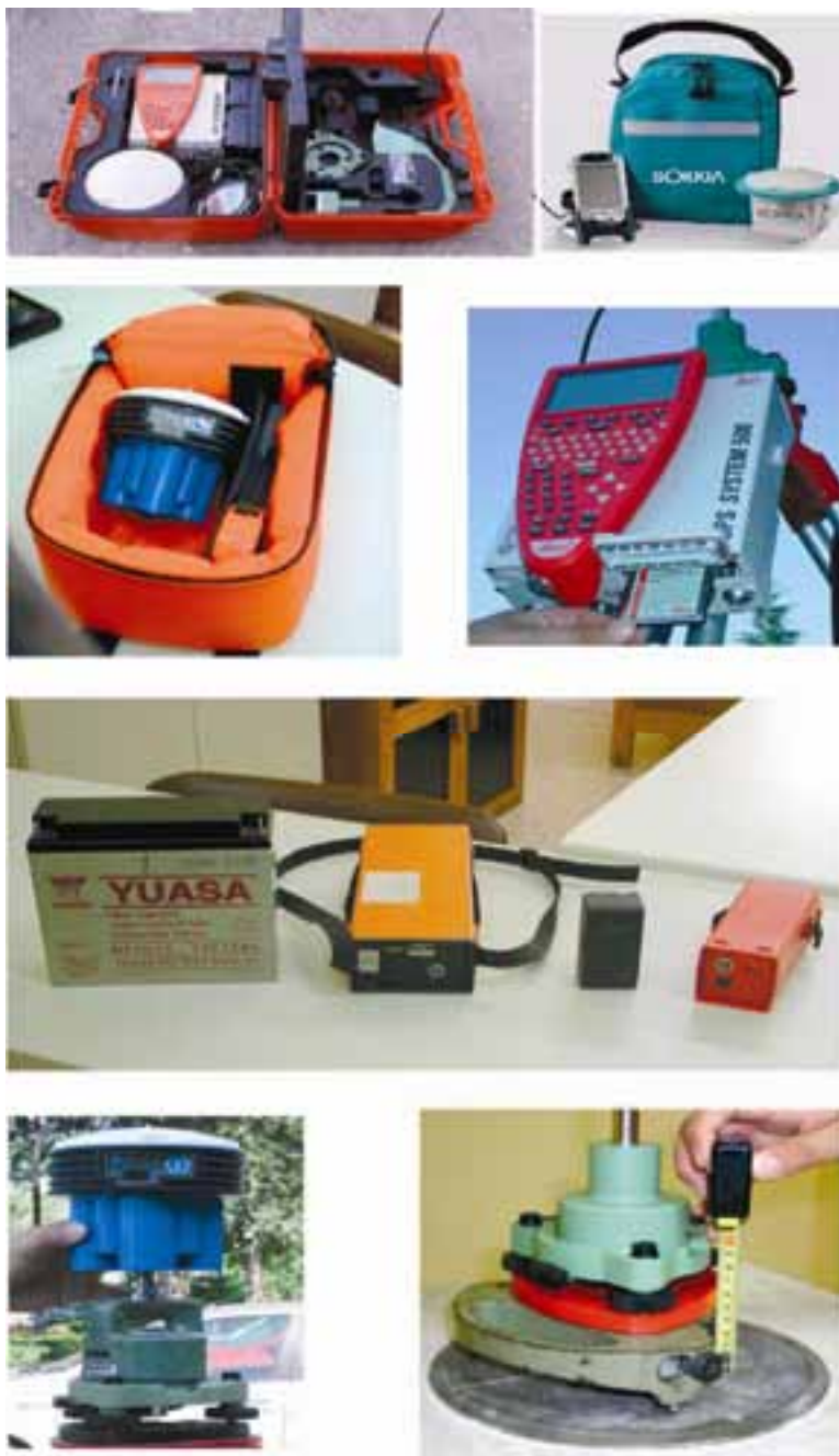
Σχήμα 3.8: Παρελκόμενος εξοπλισμός GPS: Θήκες μεταφοράς, κάρτα μνήμης, μπαταρίες, τρικόχλια, προσαρμοστής κεραίας, βάση κέντρωσης.
