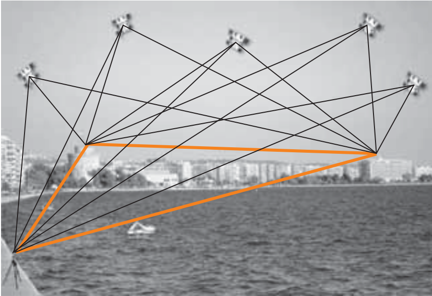
Σχήμα 1.4: Σχετικός προσδιορισμός θέσης με χρήση τριών δεκτών GPS που μετρούν ταυτόχρονα πέντε δορυφόρους.
