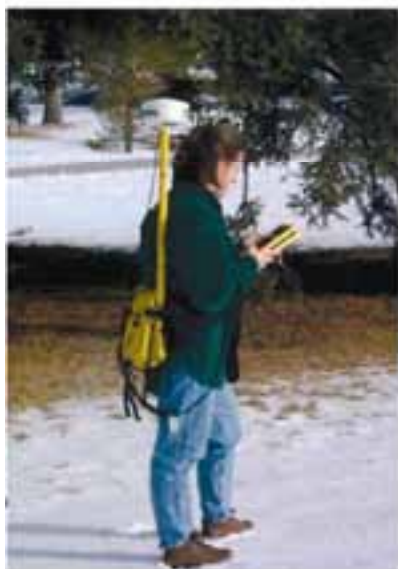
Σχήμα 3.4: Ανάπτυξη κεραιών GPS (με χειριστήρια-καταγραφικά και συσκευή ραδιο-επικοινωνίας) σε στυλέο και κεραιάς-δέκτη σε διάταξη σακιδίου πλάτης.
