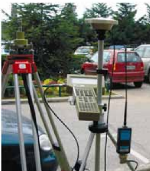
Σχήμα 3.4: Ανάπτυξη κεραιών GPS (με χειριστήρια-καταγραφικά και συσκευή ραδιο-επικοινωνίας) σε στυλέο και κεραιάς-δέκτη σε διάταξη σακιδίου πλάτης.
