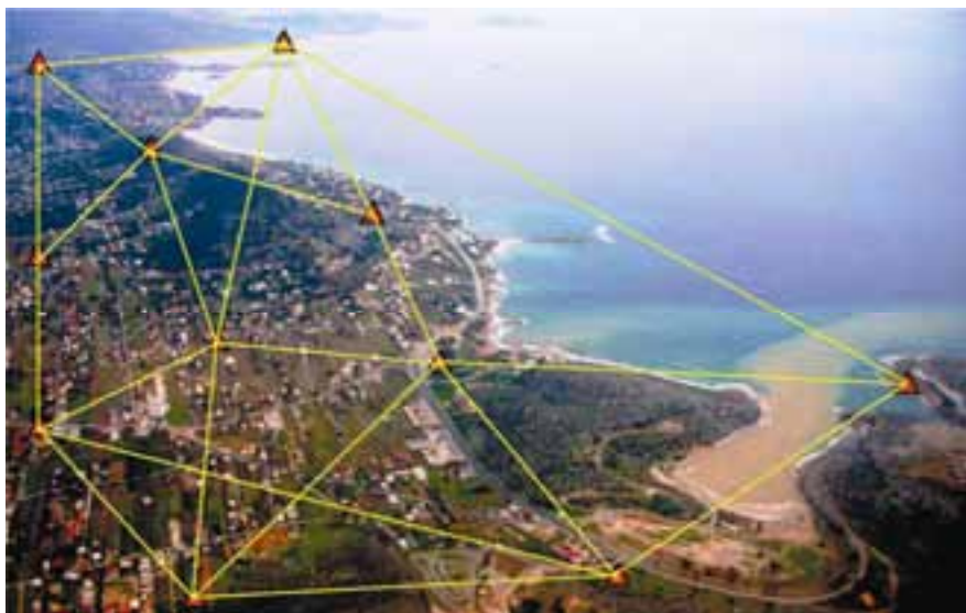
Σχήμα 3.10: Ίδρυση δικτύου GPS – εφαρμογές υψηλής ακρίβειας με χρήση γεωδαιτικών δεκτών (L1/L2).
